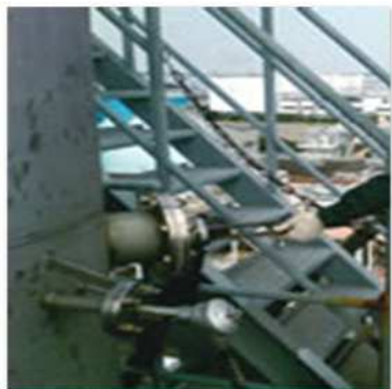
工場の立入によるばい煙測定
