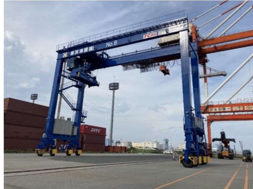
図 川崎港コンテナターミナルに導入された脱炭素型R
