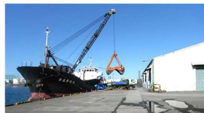
川崎港に入港する砂利・砂船の平均総トン数：約500GT ⇒ 必要な岸壁水深4.5m以上
