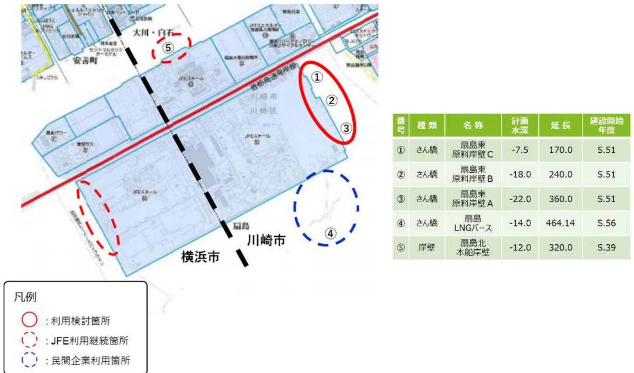
【図 扇島内の主なバースの配置状況】
