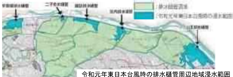
令和元年東日本台風時の排水樋管周辺地域浸水範囲
