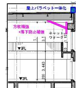
（体育館棟の耐震補強）
