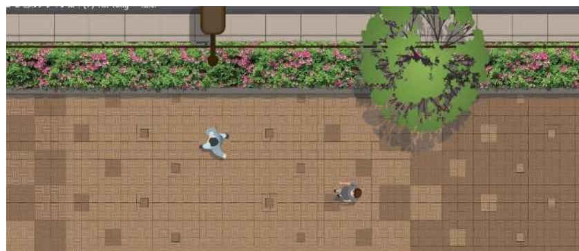
歩道部インターロッキング舗装
