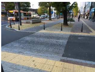
フラットな舗装の切り替え・舗装による視覚的な動線計画(姫路大手前通りほか)
