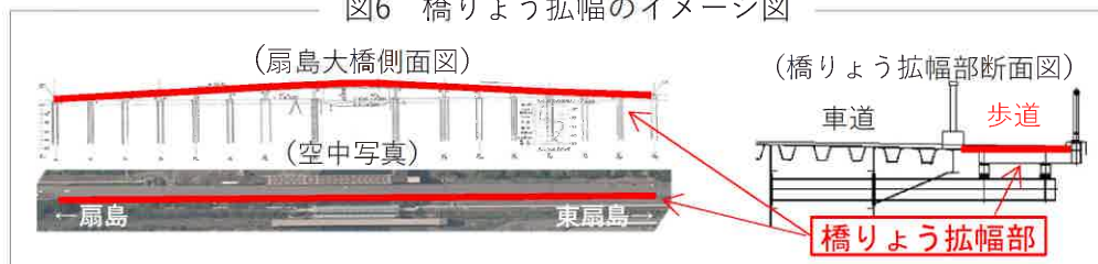
図6 橋りょう拡幅のイメージ図
