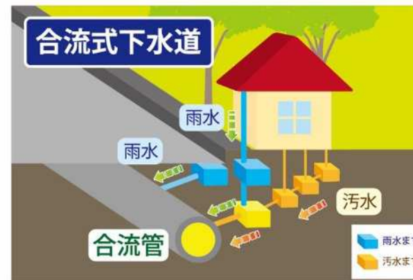
● 汚水と雨水を1本の管で一緒に流す方法
