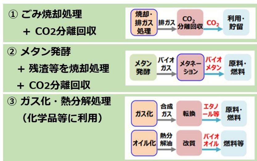
図 27 CCUS 技術を導入した廃棄物処理システム
