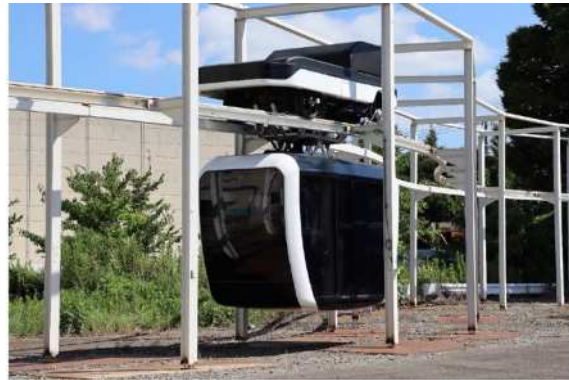
図 自走式ロープウェイの走行実験(秦野市内)
