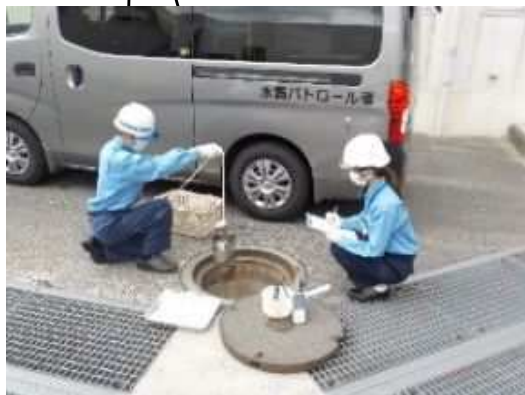
事業場排水採水状況
