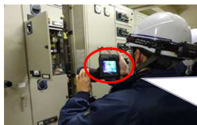
赤外線サーモグラフィを用いた熱画像診断
