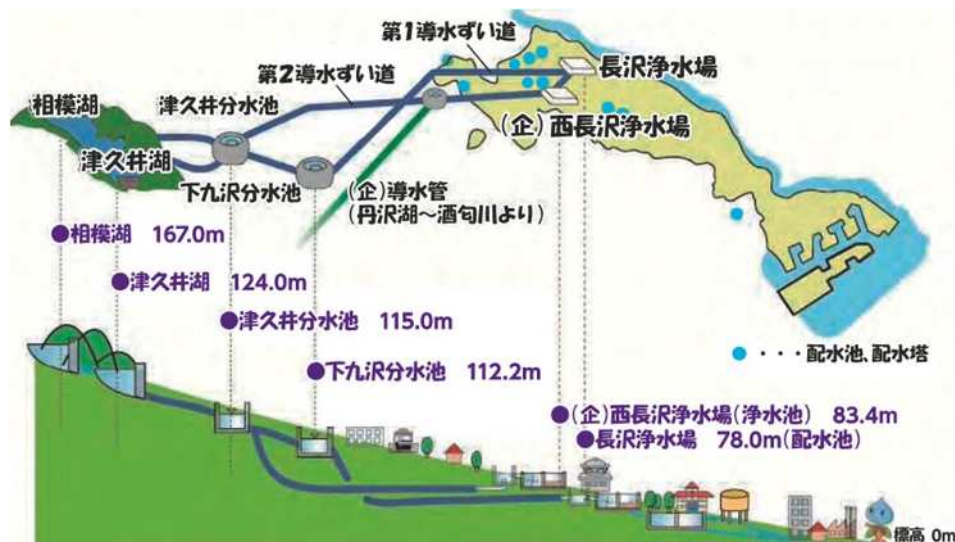
自然流下による水道システムのイメージ
