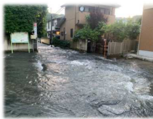
老朽化した水道管による漏水(冠水) (神奈川県提供)
