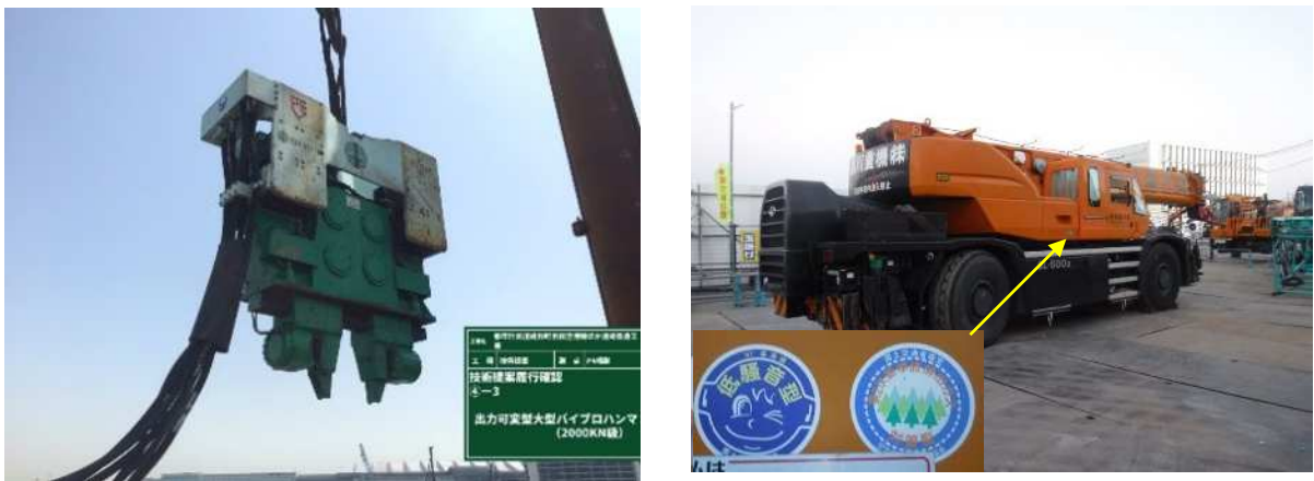
写真 2-50 建設機械(左：特殊バイブロハンマ使用、右：低騒音型建設機械)
