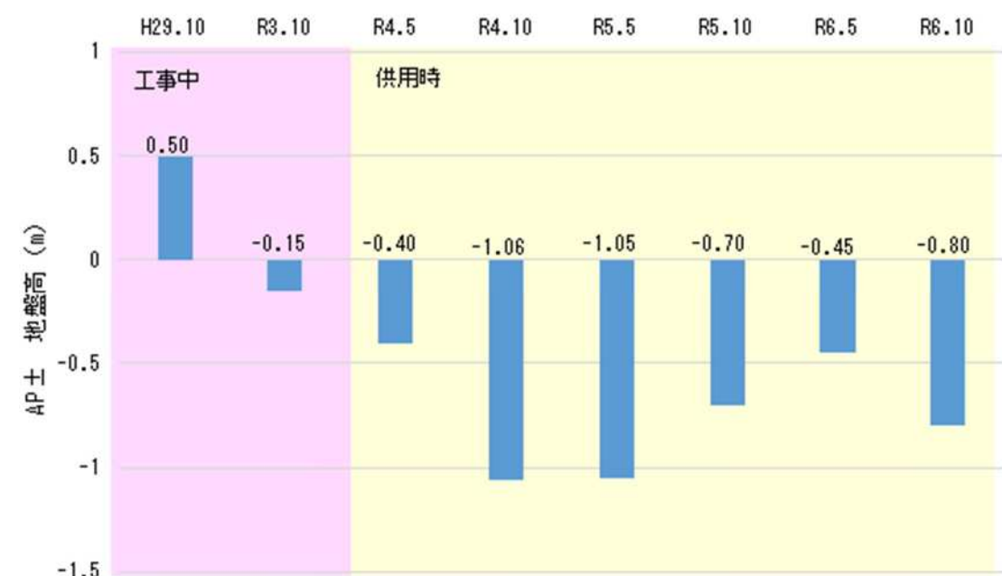
図 3-14 P3 橋脚付近の地盤高の変化
