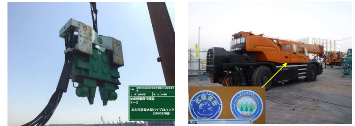
写真 2-50 建設機械(左：特殊バイブロハンマ使用、右：低騒音型建設機械)
