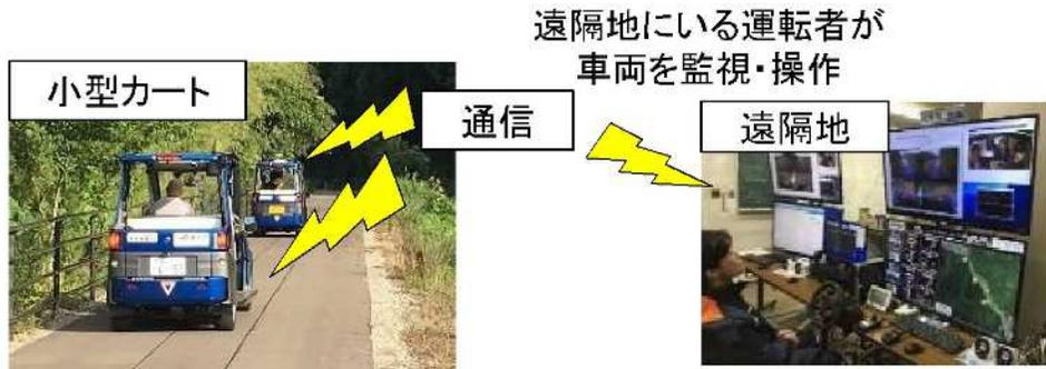
遠隔監視・操作型のラストマイル自動運転の実証実験
