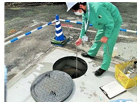
工場の立入りによる排水検査
