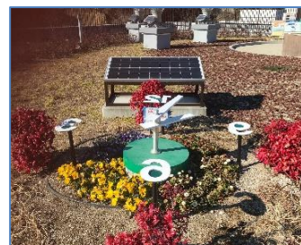
屋上庭園のソーラー花時計。 上方の太陽光パネルで発電した電気で時計の針が動く
