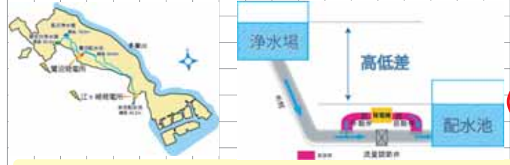
鷺沼、江ヶ崎発電所の位置 小水力発電の仕組み
