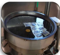
朝一番に回転釜で麦茶を作ります。1回で30リットルできます。
