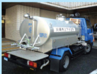
2トンの給水タンク車
