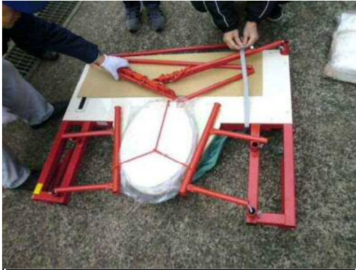
①箱の中から「架台」と「前架台」を取り出し、折り畳まれた脚を起こして、2つをつなげる。
