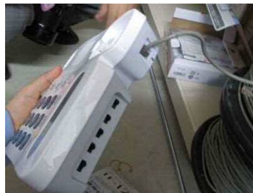
特設公衆電話機とコードの接続
