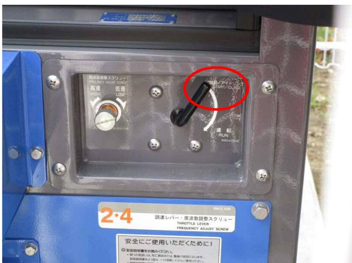
③発電機の鍵を差込み、「余熱・運転」へ回す。余熱ランプが消えたら鍵を「始動」へ回す。
