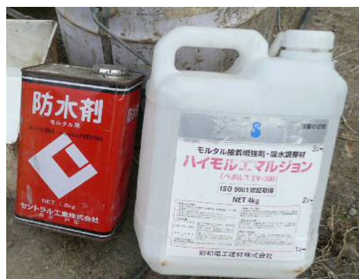
写真3 使用した防水材と接着増強剤
