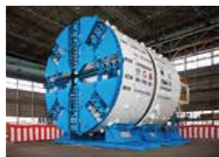
トンネル掘削機「シールドマシン」
