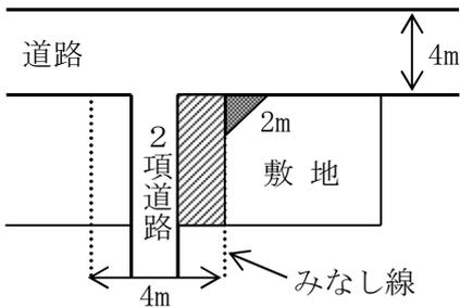
2項道路のセットバック部分を整備し、かつ、底辺が2mのすみ切りを整備していれば角地緩和を適用。
