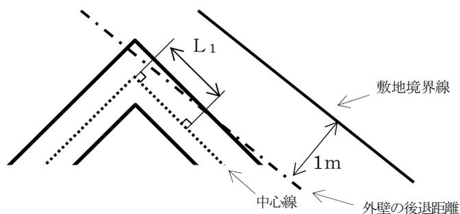
外壁の後退距離と外壁面の交点から中心線に対して垂線が下ろせない場合
