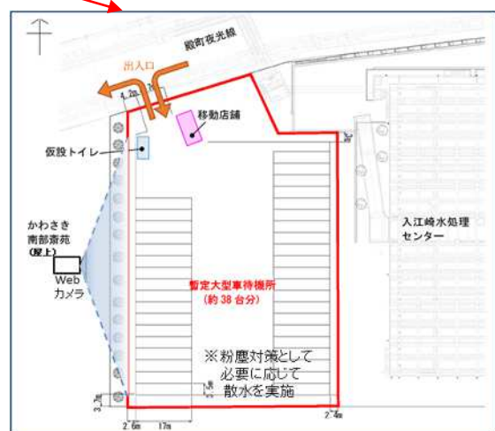
図4 入江崎水処理センター西系処理施設敷地内の仮設トラック待機所イメージ
