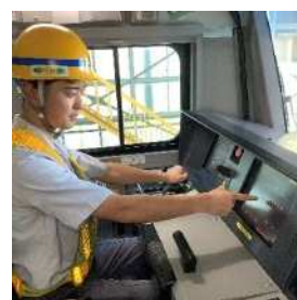
⑥運転台にてブレーキの動作確認
