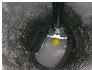
污水管損傷簡易検査具「通る君」
