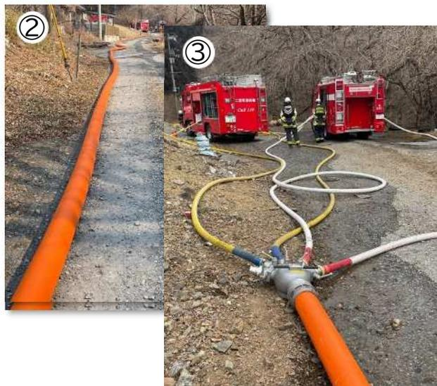
遠距離大量送水隊は、川崎市消防局中原消防署に配置されており、中原大型ポンプ隊の車両積載クレーンで大型ポンプを海に投入して海水を吸い上げ、中原ホース延長隊により大口径(150ミリ)の送水ホースを約1.8キロメートル先まで延長し、4000リットル/毎分以上を送水することが可能です。
