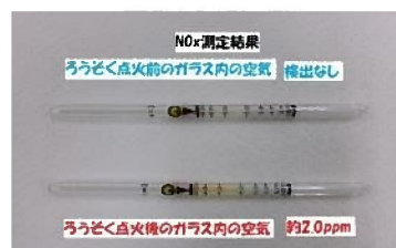
← ↑ 検知管を使った大気汚染物質の測定実験
