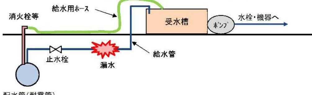
〔消火栓等を使用した直接給水のイメージ〕
