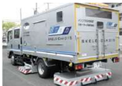
空洞調査 (路上から実施)
