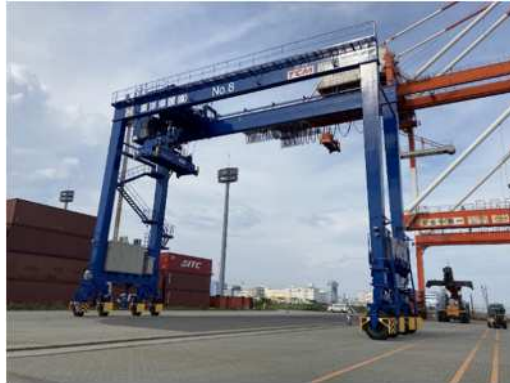
図 川崎港コンテナターミナルに導入された脱炭素型R
