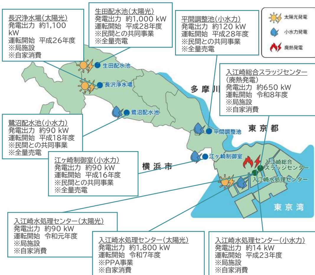
上下水道局における再生可能エネルギー利用発電設備の分布
