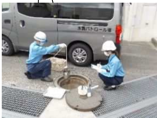
事業場排水採水状況
